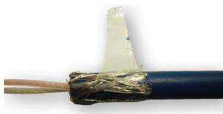
**Fig. 18-14 Ruban adhésif sur le câble capteur/blindage**
