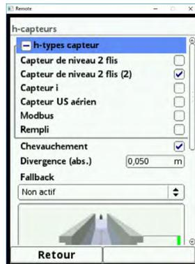
Fig. 21-6 Choix des types de capteurs h
