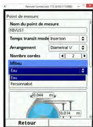
Fig. 24-2 Sélection milieu à mesurer
