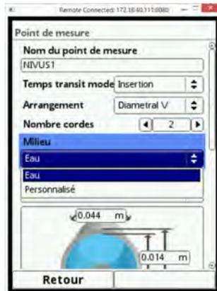
Fig. 23-3 Sélection du milieu à mesurer
