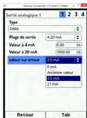
Fig. 24-6 Possibles réactions en cas d'erreur
