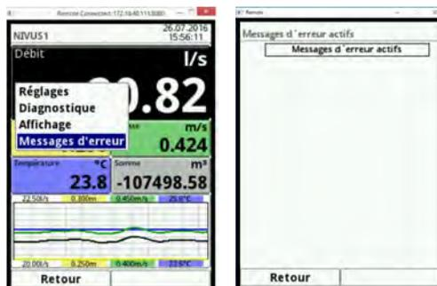
Fig. 29-5 Sélection et affichage messages d'erreur
